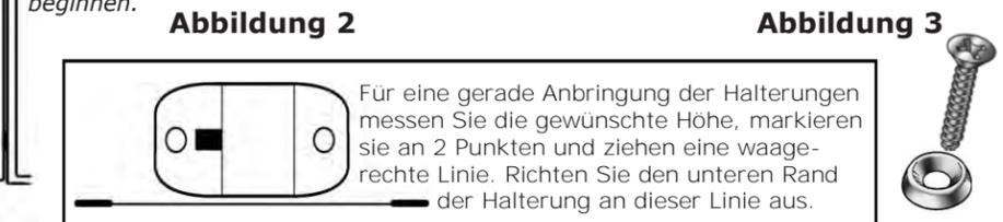
1. **Anbringung der Halterungen:** Die vier Halterungen müssen so angebracht werden, dass jede horizontal und waagrecht sitzt. (Abb. 2). Wenn das Schutzrollo an Hartholz oder Metallständerwänden montiert wird, ist ein Vorbohren von Ø 2,8 mm Bohrlöchern für die Anbringung der Wandhalterungen erforderlich. Bitte ziehen Sie die Schrauben immer von Hand fest, um Beschädigungen zu vermeiden - **benutzen Sie keinen elektrischen Bohrschrauber.**
